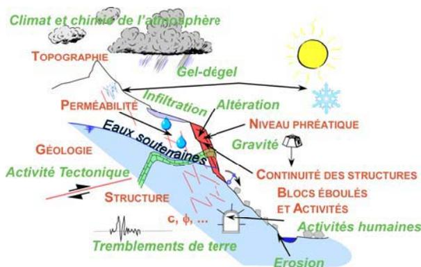
Figure 2. Illustration des concepts de paramètres intrinsèques et facteurs externes. En petites majuscules les paramètres intrinsèques et en italiques les facteurs externes (d'après Jaboyedoff *et al.* 2003).
