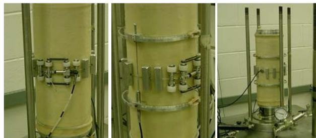
Figure 5. Installation des capteurs de déplacement et du capteur de succion matricielle.
