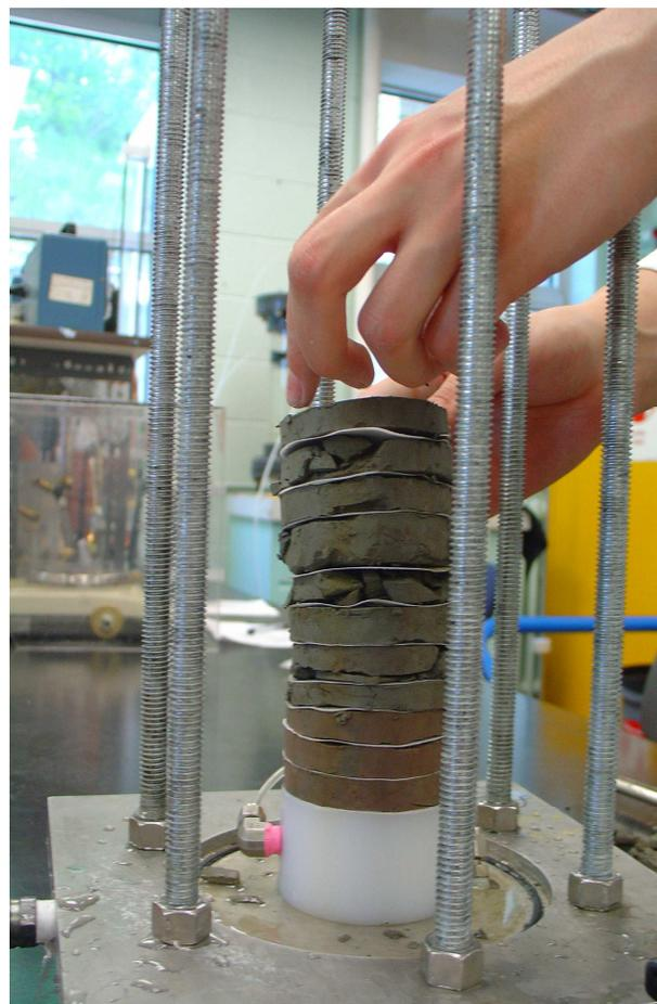
Figure 2 : Préparation et montage de l'échantillon d'argile
