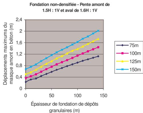
Figure 8 : Déplacements totaux maximums (m) du masque amont pour des barrages CFRD de différentes hauteurs H (m), avec des pentes amont de 1.5H : 1V et aval de 1.6H : 1V, reposant sur le substratum rocheux ou sur des dépôts granulaires (phase du remplissage du réservoir).
