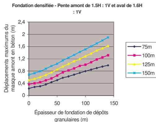
Figure 9 : Déplacements totaux maximums (m) du masque amont pour des barrages CFRD de différentes hauteurs H (m), avec des pentes amont de 1.5H : 1V et aval de 1.6H : 1V, reposant sur le substratum rocheux ou sur des dépôts granulaires densifiés sur une profondeur de 30 m (phase du remplissage du réservoir).
