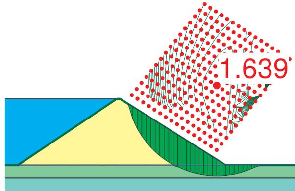
Figure 3 : Coefficient de sécurité à la fin du remplissage du réservoir, pour un barrage CFRD de 150 m de hauteur avec des pentes amont de 1,5H : 1V et aval de 1,6H : 1V, reposant sur 60 m de dépôts granulaires.
