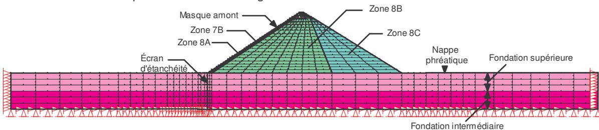
Figure 1 : Barrage CFRD de 100 m de hauteur, avec des pentes amont de 1,5H : 1V et aval de 1,6H : 1V, reposant sur 60 m de dépôts granulaires.
