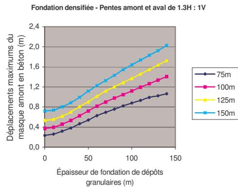
Figure 6 : Déplacements totaux maximums (m) du masque amont pour des barrages CFRD de différentes hauteurs H (m), avec des pentes amont et aval de 1,3H : 1V, reposant sur le substratum rocheux ou sur des dépôts granulaires (phase de remplissage du réservoir).
