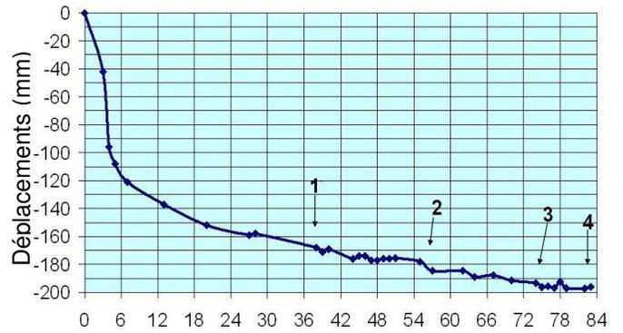
Figure 8 : Déplacements verticaux mesurés en crête du barrage « West Dam » en fonction du temps.
