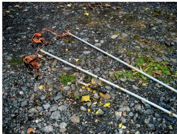
Figure 5. Tubes porte-électrodes pour les mesures en forage.
