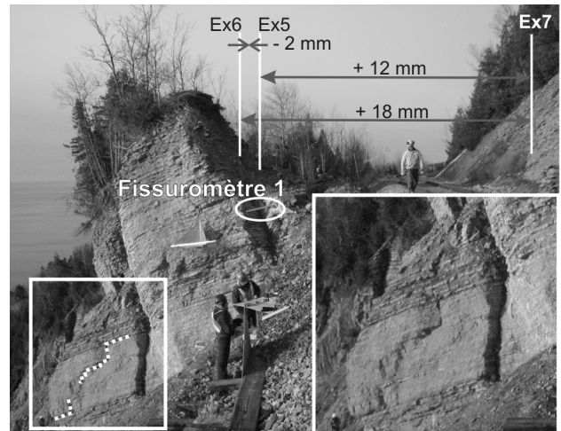
Figure 6. Formes en échelons (traits pointillés). Le fissuromètre 1 se referme depuis son installation. Les flèches indiquent les déplacements mesurés sur les tiges extensométriques, EX5, 6 et 7 (vue vers l'ouest).
