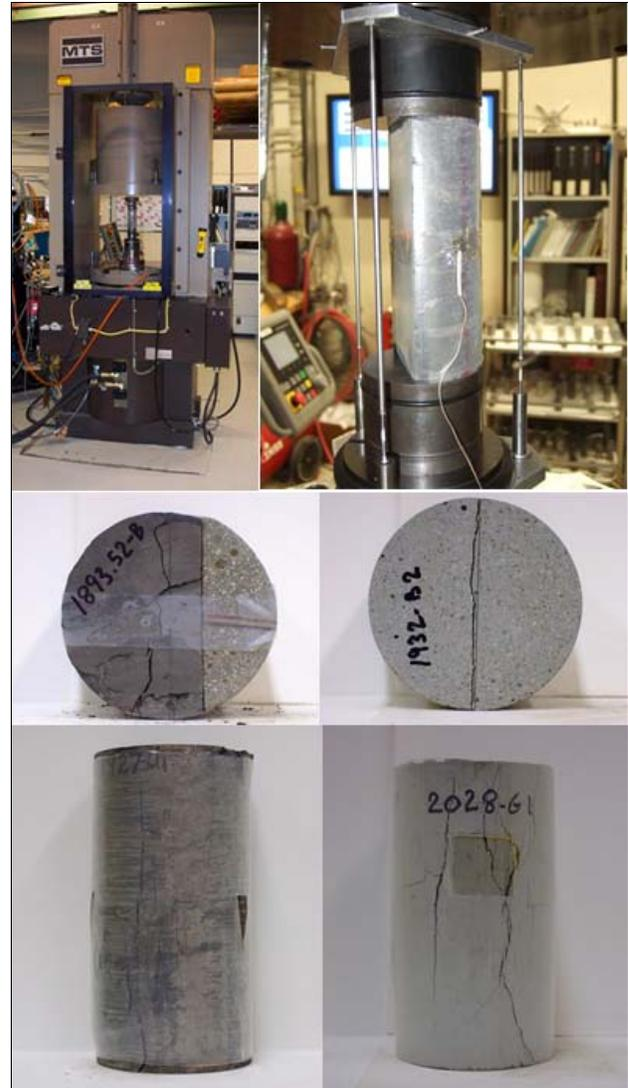
Figure 4. Équipement de chargement et montage d'essai utilisés pour les essais (haut), et exemples d'éprouvettes brisées tel qu'observées à la fin du programme d'essai en laboratoire (milieu et bas).
