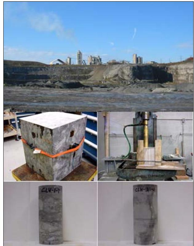
Figure 2. Forage et rectification en laboratoire des éprouvettes de calcaire de Cobourg à partir de blocs de roche prélevés à la carrière Saint-Mary's Cement®, Bowmanville, Ontario.
