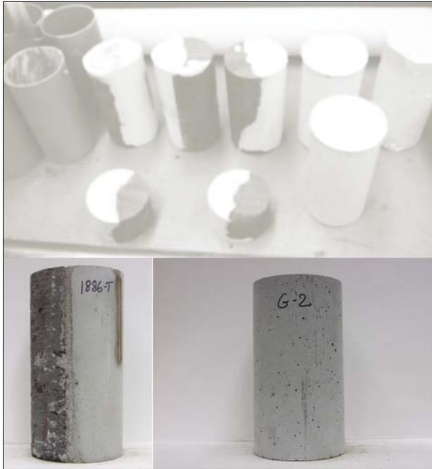
Figure 3. Coulée et façonnage en laboratoire d'éprouvettes de gypse et de ciment, et compensation des éprouvettes de shale sciées fournies par le Ministère (MERN).
