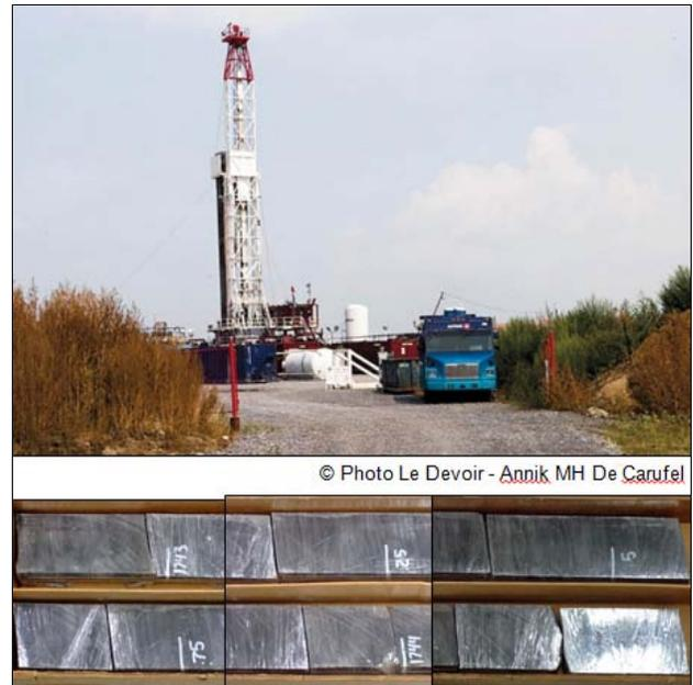
Figure 1. Forage dans les basses-terres du Saint-Laurent et carottage à l'intérieur du Groupe de Lorraine et de Shale d'Utica, région de Lotbinière, Québec (haut); éprouvettes sciées lors de la description géologique pour fin d'analyse et archivage (bas).
