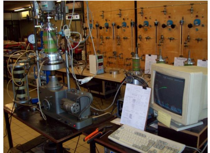
Figure 6. Dispositif de tout l'appareillage triaxial pour des essais consolidés non drainés (CU) et des essais non consolidés non drainés (UU) au laboratoire LEMSC de l'UCL
